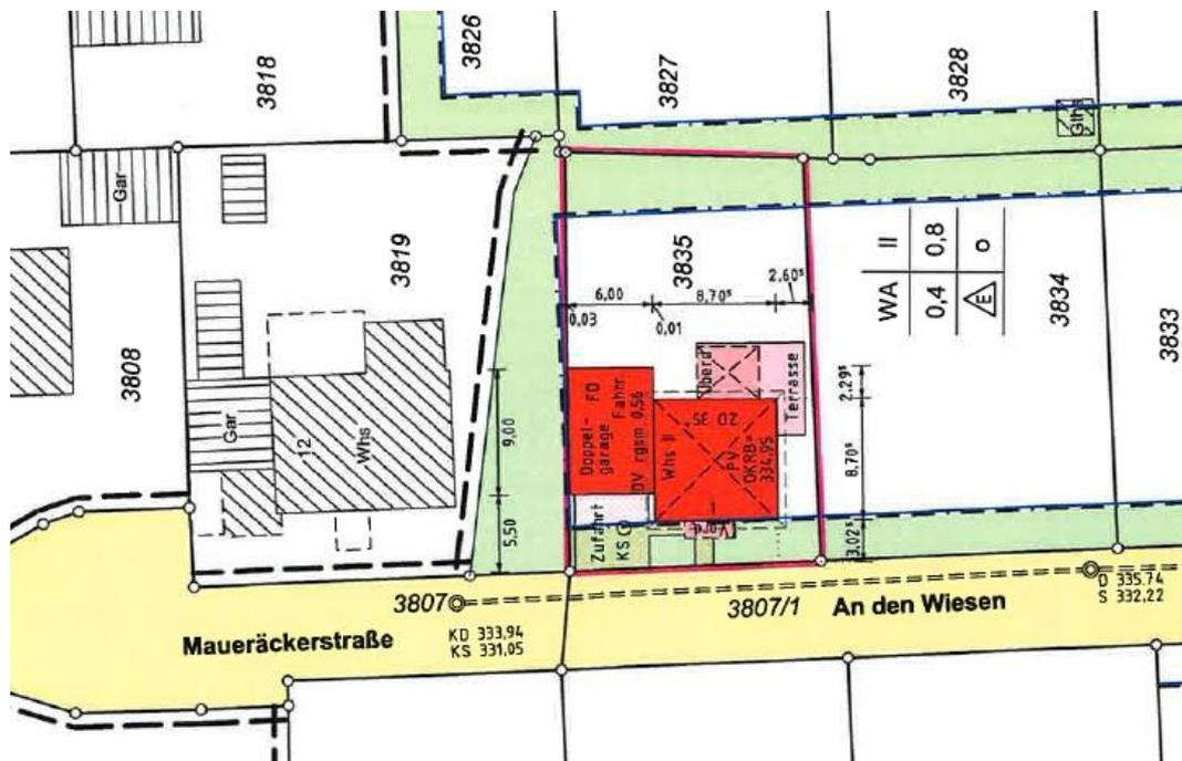
Der Bauherr plant hier den Bau eines Wohnhauses als Holzständerkonstruktion mit zusätzlicher Außendämmung und einer Doppel-Garage als Fertigbauteil mit Flachdach.
