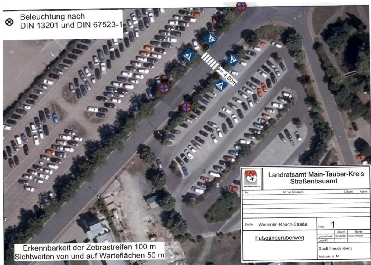
Für die Beleuchtung des FGÜ müssen zwei Straßenlaternen aufgestellt werden. Eine Beschilderung für den FGÜ und Halteverbotsschilder sind aufzustellen. Durch Rückschnitt der Anpflanzungen ist sicherzustellen, dass die Sichtweiten für die Erkennbarkeit des FGÜ von 100m und die Sichtweiten von und auf die Warteflächen aus 50m gewährleistet sind.
