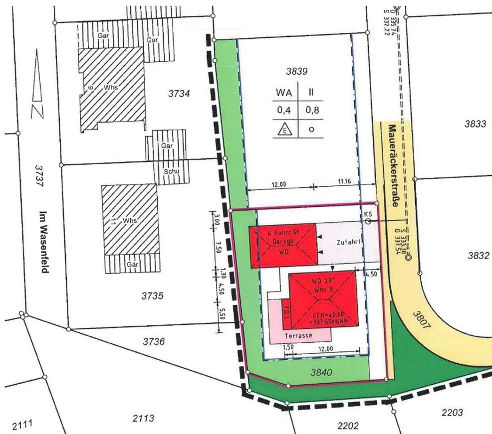
Der Bauherr plant den Bau eines massiven Wohnhauses mit zwei Vollgeschossen. Das geplante Walmdach soll eine Dachneigung von 23° und eine anthrazitfarbene Eindeckung erhalten.
