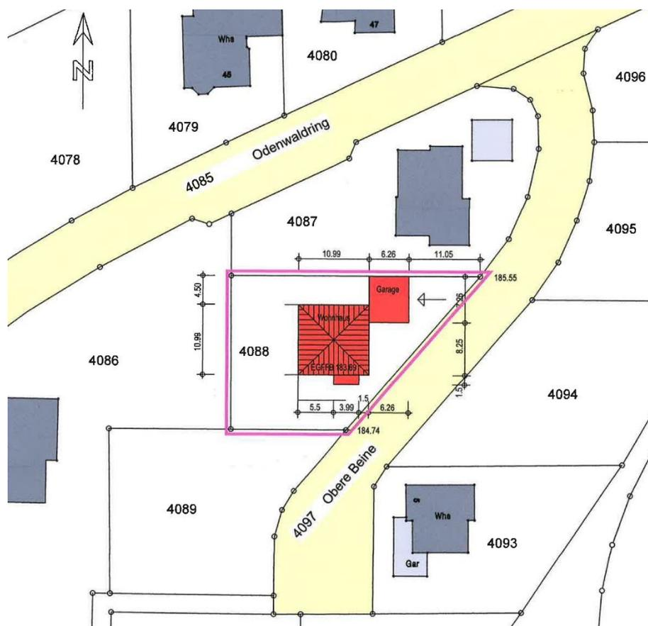
Der Bauherr plant nun einen Zaun entlang seiner Grundstücksgrenze, wie durch die grüne Linie im nachfolgenden Grundrissplan dargestellt, zu errichten. Der Zaun besteht aus Pfosten aus Aluminium mit quadratischen Querschnitt 85 x 85 mm und einer Höhe von 1,50 m.
