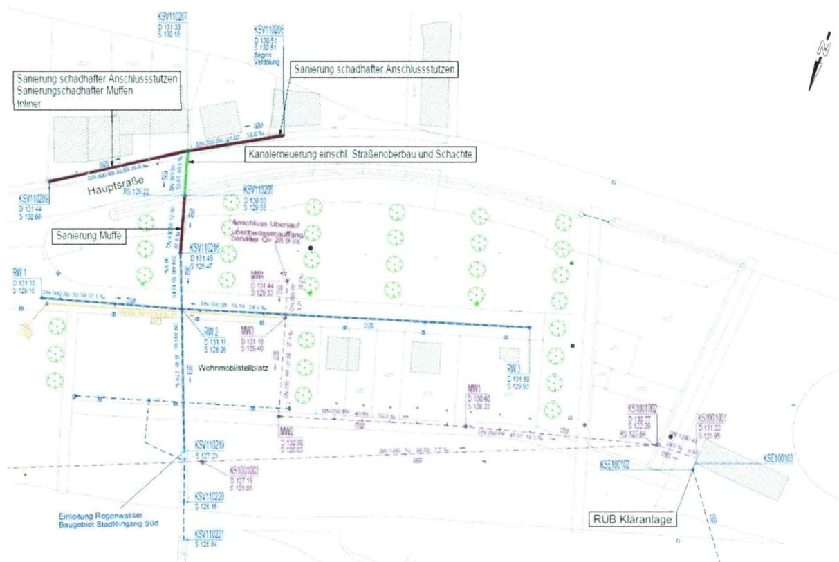
Die Auswertung der im Oktober 2020 durchgeführten Videoinspektion zeigte, dass insbesondere in den Kanalhaltungen nahe der Hauptstraße erhebliche Schäden durch Muffenversatz, gebrochene Rohre und Rohreinbrüche vorhanden sind.
