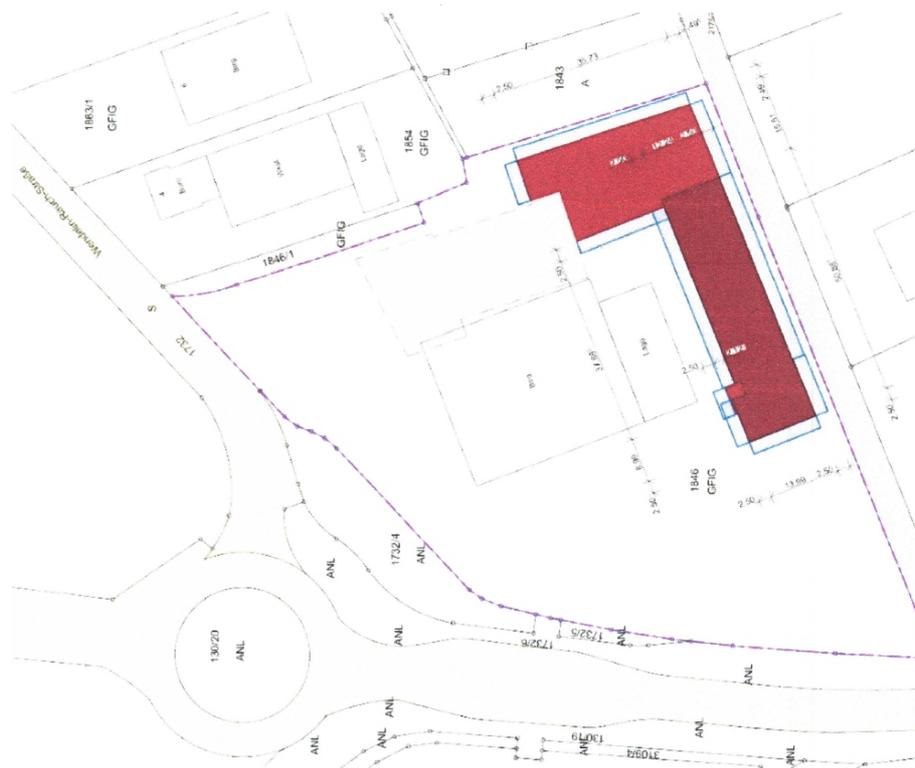
Die Gebäude für die Feuerwehr und den Bauhof werden an der östlichen bzw. der südlichen Grundstücksgrenze in Massivbauweise errichtet und durch ein überdachtes Materiallager verbunden. Hier stehen derzeit noch Bestandsgebäude (ehemals Zimmereihalle und Wohnhaus), die für die spätere Nutzung des Flurstücks als Feuerwehr- und Bauhofstandort im Zuge der Baumaßnahme zurückgebaut werden.
