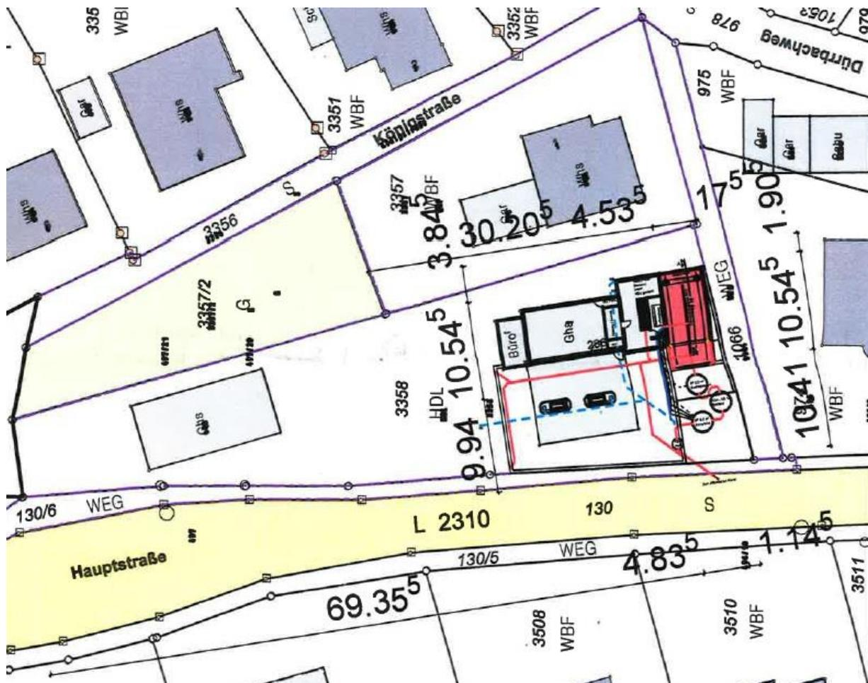
Der Bauherr plant hier die Verlegung der Waschanlage in den rechten Gebäudeteil, der bisher als Lager genutzt wurde. Der Lagerraum soll um 1,00 m erhöht und zur Hauptstraße hin um 2,50 m verlängert werden, damit hier die neue Waschanlage eingebaut werden kann.
