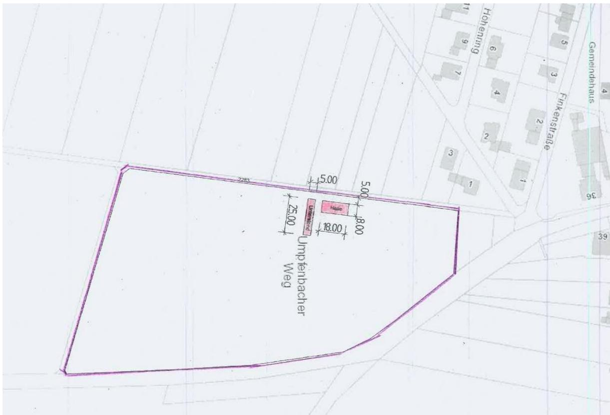
Der Bauherr plant hier den Bau einer Halle als Unterstellmöglichkeit für das vorhandene landwirtschaftliches Gerät und den Bau eines Unterstandes, um 10 Zwergzebus in Freilandhaltung optimal vor Ort mit Futter und Wasser versorgen können. Halle und Unterstand sollen auf einer Grundfläche von 18,0 m x 8,0 m bzw. 25,0 m x 5,0 m errichtet werden.
